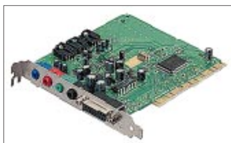
Bild 4: Sound Blaster 16 PCI: preiswerte Standardkarte für unsere Zwecke. Werkfoto
