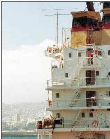
Die Antennen von DK5KK/mm und DL2NUD/mm auf dem Schiff im Hafen von Santa Cruz: 13-El.-Cushcraft für 2 m und 28-El.-Yagi für 70 cm
