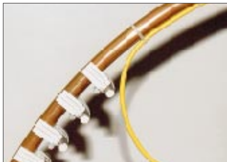
Bild 4: Ausschnitt Resonanzring mit montierten Ferritstäben und angrenzender Koppelschleife
