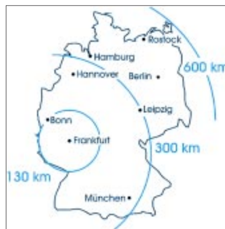
Bild 5: Der Mainflinger Sender deckt sehr zuverlässig die Bundesrepublik Deutschland mit DGPS-Korrektursignalen ab. Quelle: [1]
