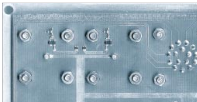
Bild 6: Leiterseite der bestückten Platine, Detailausschnitt; links oben und in der Mitte je eine N-Buchse mit Stripline-Zuführung und Richtkoppler; rechts daneben die Unterseite der Buchse X 6, die die Ausgänge der einzelnen Richtkoppler nach außen führt.
