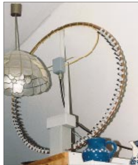
Bild 6: Reale Aufstellungssituation der Magnetantenne in der Galerie unterhalb des Firstes
