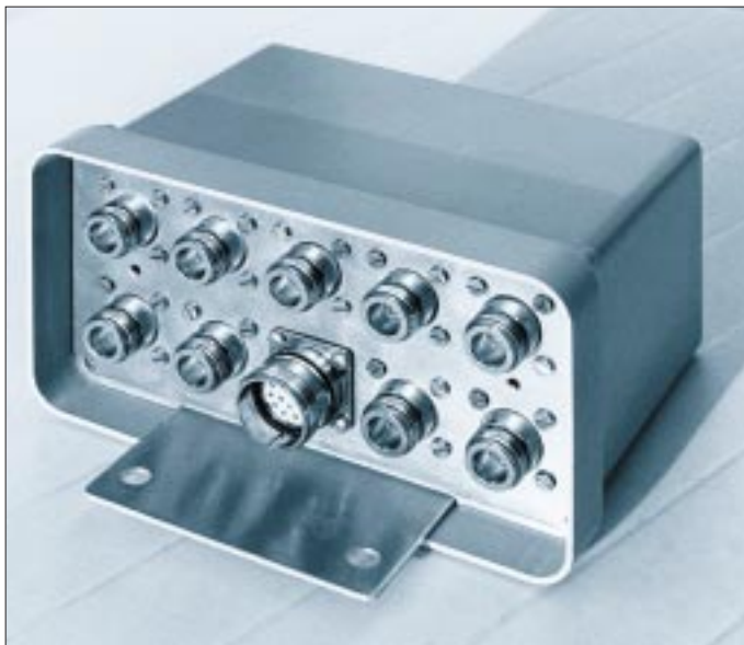
Bild 1: Vereiste Achtfach-Dipolzeile bei DB0BPY, gespeist mit dem beschriebenen Verteiler Bild 2: Der fertig aufgebaute Antennenverteiler in einem handelsüblichen Mastgehäuse
