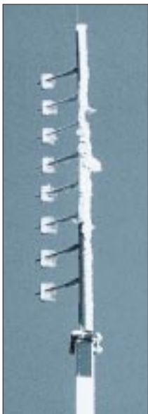
Bild 1: Vereiste Achtfach-Dipolzeile bei DB0BPY, gespeist mit dem beschriebenen Verteiler Bild 2: Der fertig aufgebaute Antennenverteiler in einem handelsüblichen Mastgehäuse
